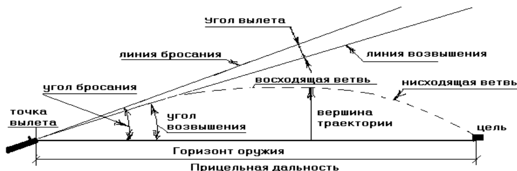
Рис. 3. Элементы траектории полета пули
