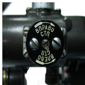
Рис. 31. Направление вращения маховиков для перемещения средней точки попадания (СТП) при стрельбе: А – верхний маховик; Б – боковой маховик
