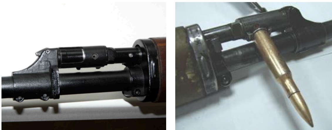
Рис. 19. Перестановка газового регулятора: А- положение 1; Б – использование закраины гильзы патрона для поворота газового регулятора.
