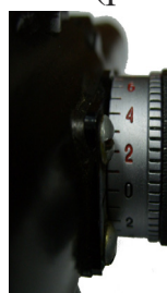
Рис. 30. Верхний и боковой маховики для регулировки оптического прицела ПСО-1: А – верхний маховик; Б – боковой маховик
