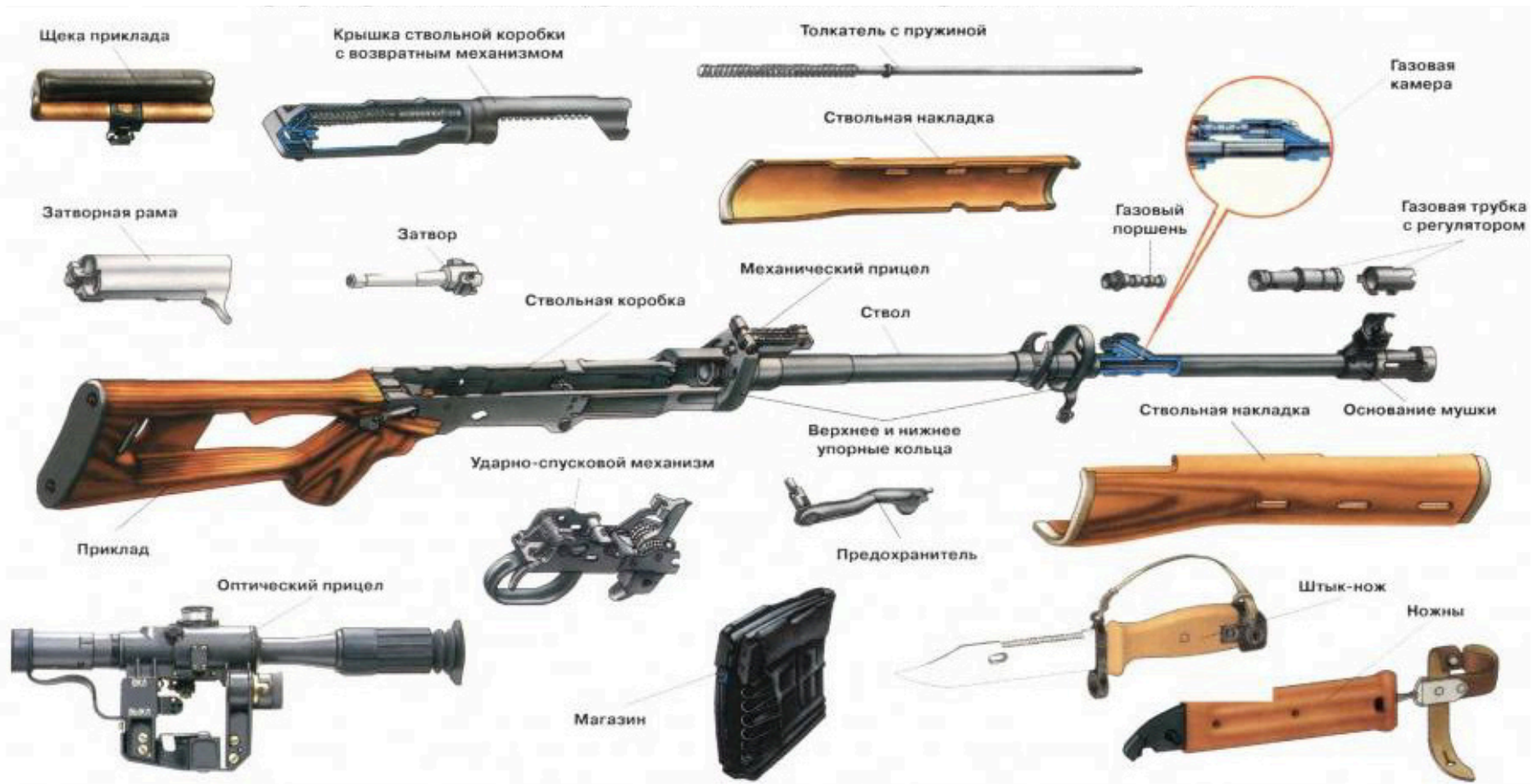
Рис. 16. Устройство снайперской винтовки Драгунова (СВД)
