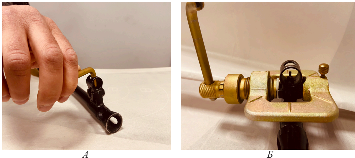
Рис.34. Введение поправок в прицел СВД: А – регулировка мушки по высоте; Б – перемещение мушки по горизонтали
