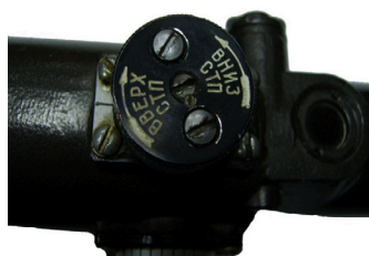
Рис. 31. Направление вращения маховиков для перемещения средней точки попадания (СТП) при стрельбе: А – верхний маховик; Б – боковой маховик
