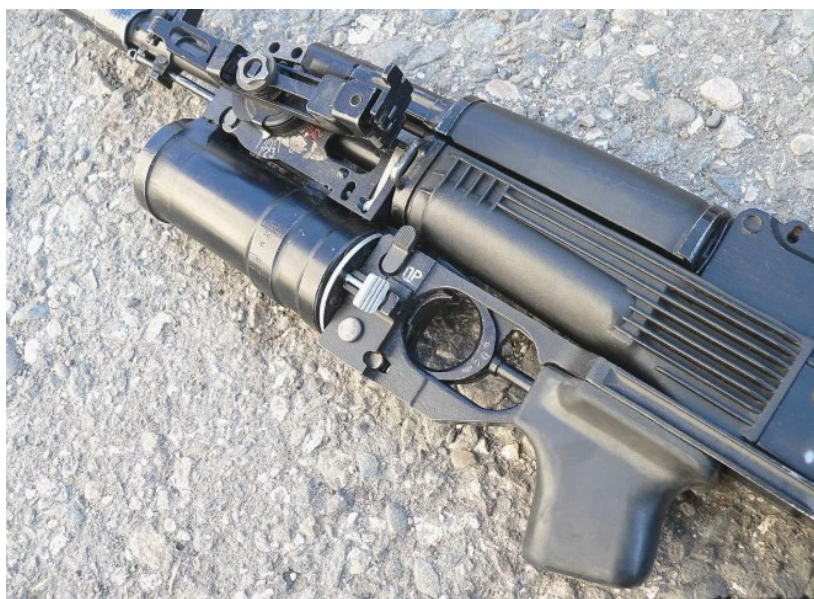
Рисунок 52. Гранатомет ГП-25 на АК 74М
