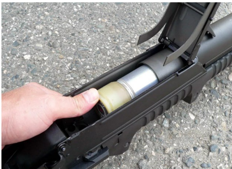
Рисунок 127. Расположение гранат в трубчатом магазине
