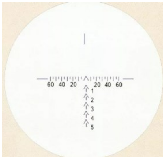
Рисунок 113. Определение упреждения по сетке прицела ПАГ-17
