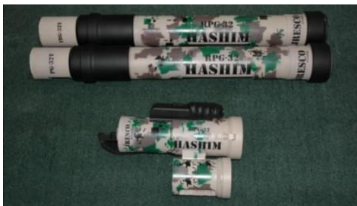
Рисунок 41. – Пусковое устройство реактивного противотанкового гранатомета РПГ-32 «Хашим» и пусковые контейнеры со 105мм гранатами
