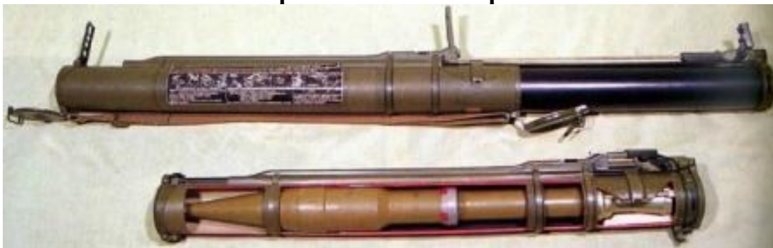
Рисунок 28. Реактивная противотанковая граната РПГ-18, сверху в боевом положении, снизу - разрезной макет в походном положении
