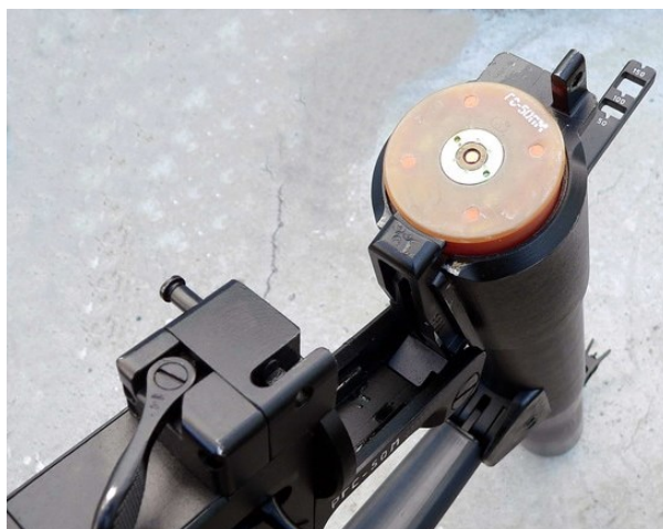
Рисунок 122. Заряжание гранатомета РГС-50М
